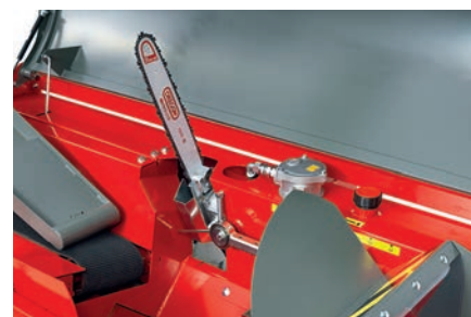
Efektivní, hydraulicky poháněná lišta.
