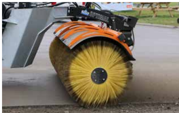
Vertikálně a horizontálně kyvný kartáč v taženém připojení dokonale sleduje řízení. Integrovaná zástěrka za kartáčem.
