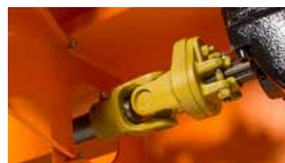
Vysoce spolehlivé - provoz podávacího šneku a rotoru chráněn spojovacím zařízením se střížnými šrouby.
