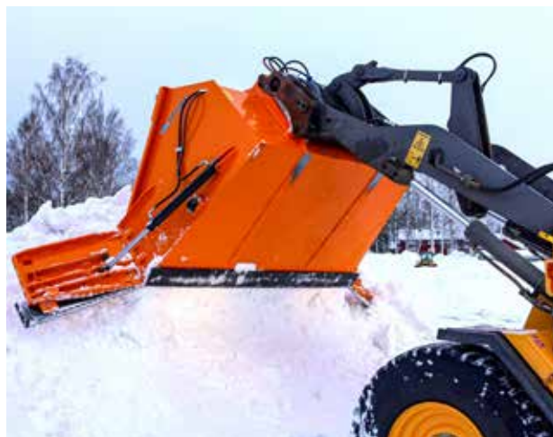
Odklízeací lopata dokáže pojmout velké množství sněhu. Lopata má kónický tvar se zaoblenou zadní hranou pro snazší vyprázdnění.
