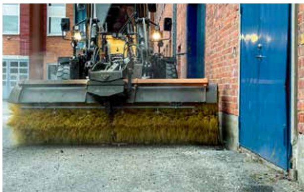
Řetězová hnací jednotka s hydraulickým motorem ve středu stroje umožňuje provoz válce těsně vedle zdi a jiných překážek.
