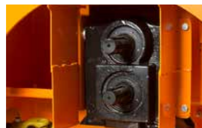
Převody HD modelů, 540 ot/min zadní montáž, 1000 ot/min přední montáž.
