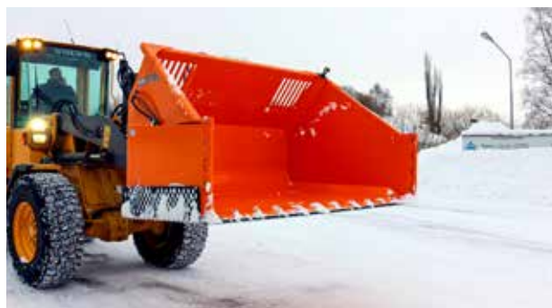
Odklízeací lopata dokáže pojmout velké množství sněhu. Lopata má kónický tvar se zaoblenou zadní hranou pro snazší vyprázdnění.
