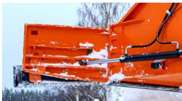
Lopata Trejon Optimal má hydraulické boční klapky, které lze sklopit o 75 stupňů dopředu a 90 stupňů dozadu. Klapky jsou opatřeny ořetovou ocelí kopírující povrch.
