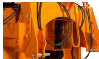
Třibodový závěs, přední nebo zadní montáž.
