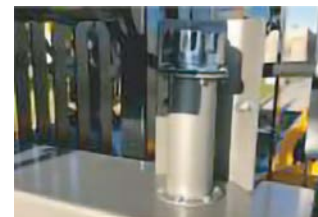
Zvýšení hrdla olejové nádrže
